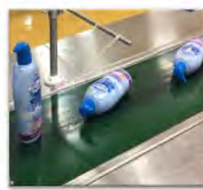
หลังการปรับปรุง ออกแบบจิ๊กเพื่อใช้แทนการจัดวาง
